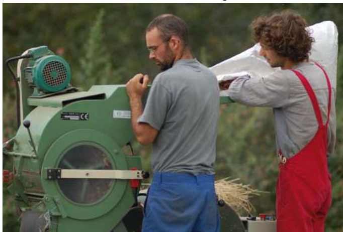
Batteuse à bottillons électrique, idéale pour battre des petites herbes
